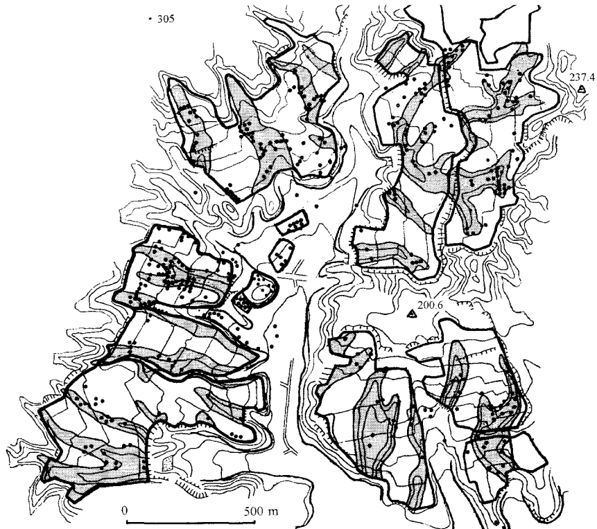
図3 住宅団地における切土盛土区分と屋根瓦破損家屋の分布
