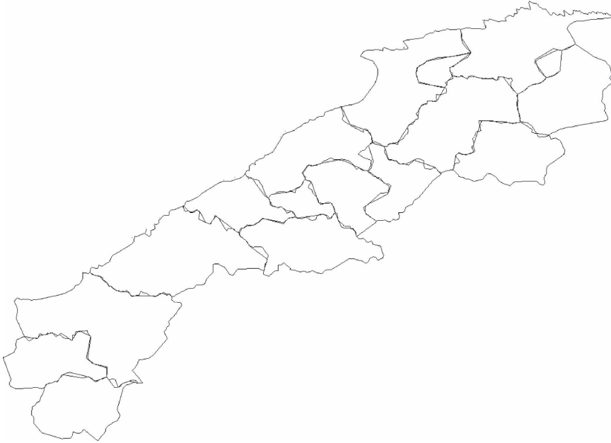
図3.1.3 Douglas-Peucker のアルゴリズムを用いた簡略化後の島根県行政区画の境界線
